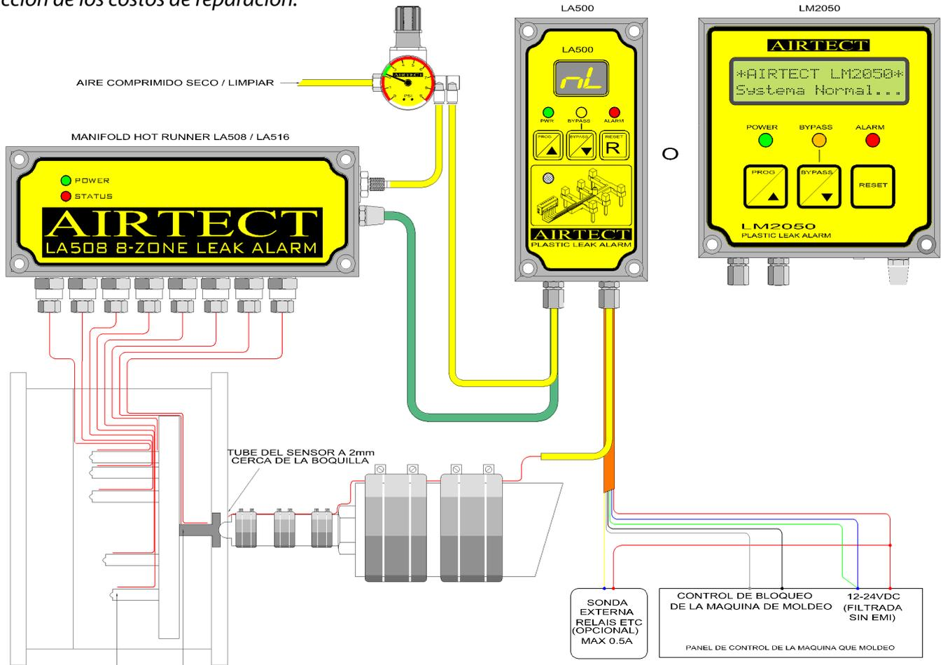
INSTALAR LOS TUBOS DE LOS SENSORES DE 2mm DE ACERO INOXIDABLE EN UBICACIONES DE FUGAS PROBALES (ELIJA CON CUIDADO SOBRE LA BASE DE DISEÑO DE MOLDES Y / O HISTORIAL DE FUGAS)
